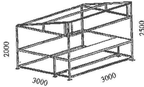
Ces éléments sont assemblés par emboîtement, tenons / godets à assemblage rapide et robuste.
